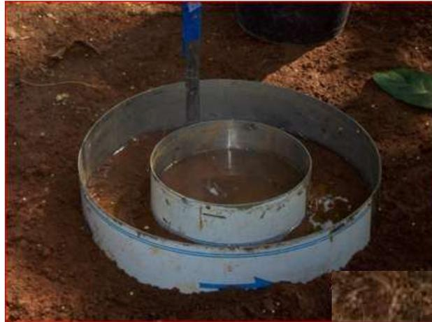
Gambar 2. Pengukuran perkolasi dengan double ring infiltrometer
