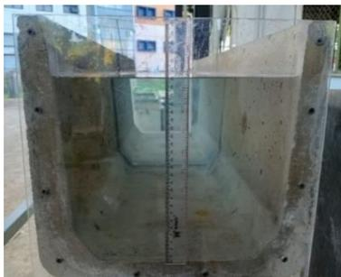
**Gambar 8.** Proses Pengujian Rembesan Air
