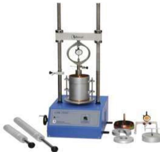
Gambar 3. Alat CBR yang digunakan dilaboratorium
